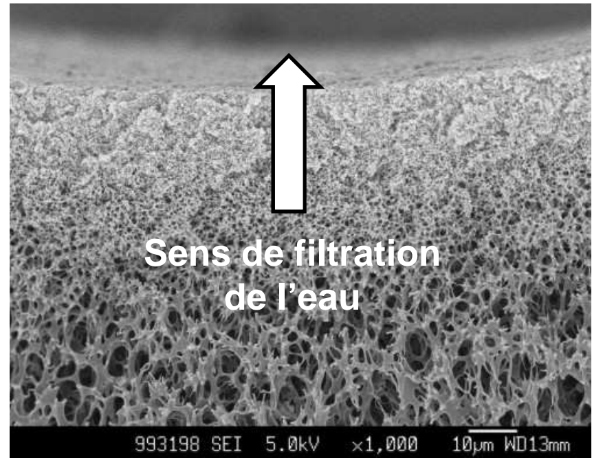
Coupe d'une membrane filtrante en profondeur
